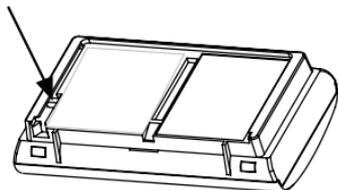
2. Une fois que l'arrière de l'unité est visible, repérez la fente élargie sur le côté inférieur gauche. Insérez un tournevis à lame plate dans la fente et faites-le glisser vers le haut de l'unité. Vous devriez sentir l'interrupteur à l'intérieur de l'unité glisser vers le haut et s'arrêter. Assurez-vous d'insérer le tournevis à angle droit et non selon un angle où vous pourriez passer à
