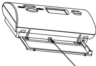
1. Retirez le support/couvercle arrière de l'unité en faisant glisser un tournevis entre l'unité et le couvercle au niveau de l'évidement au centre du boîtier. Cela vous permettra d'accéder à l'arrière de l'unité.
